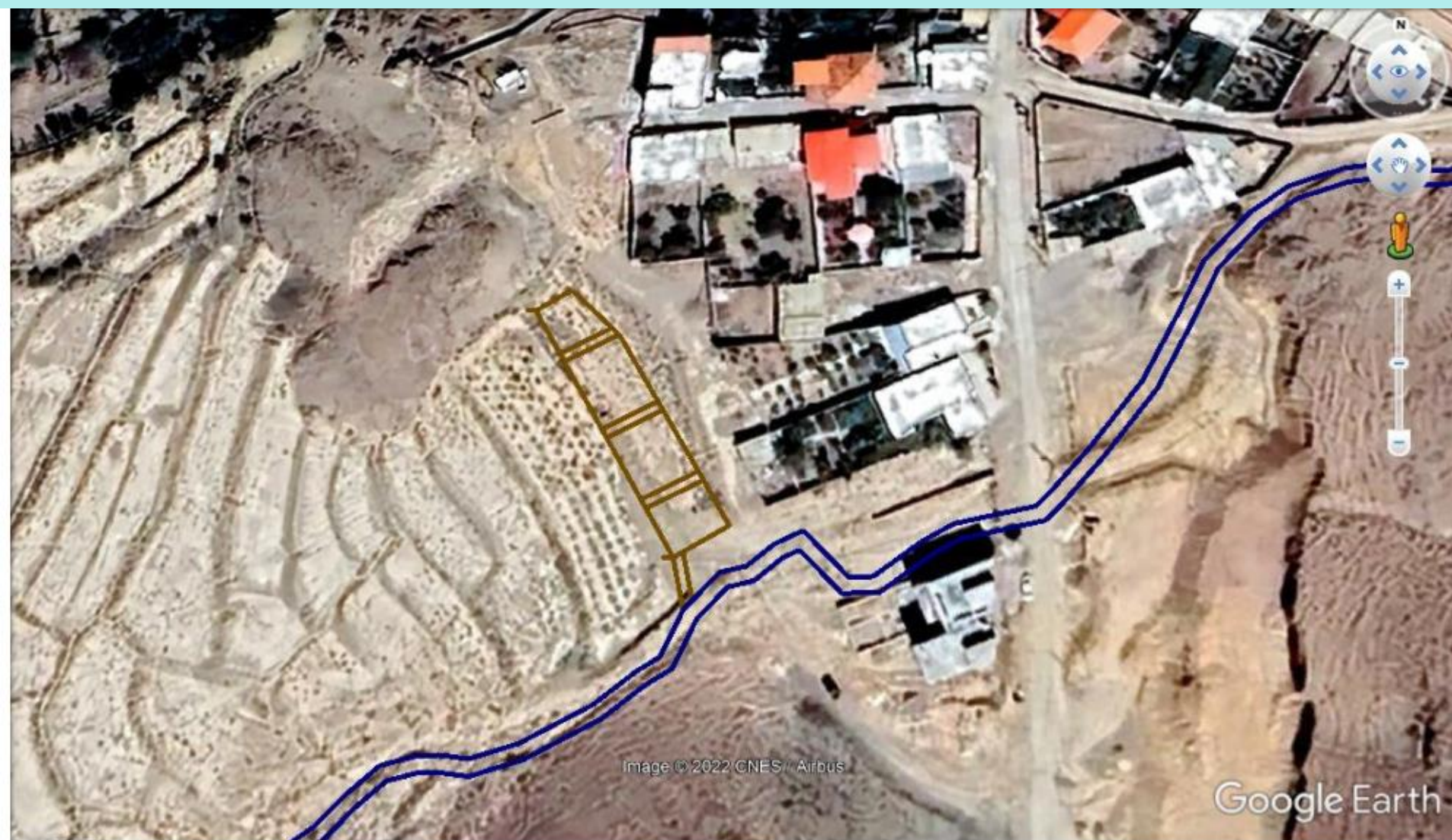
موقعیت سازه گوره و سیل بند (خط قهوه ای) به ارتفاع ۲ متر و سرریز به سمت کانال
